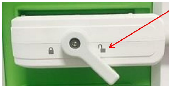
Εικόνα 11: Ξεκλειδωτός επιλογέας ασφάλισης συνδέσμου ηχοβολέα
